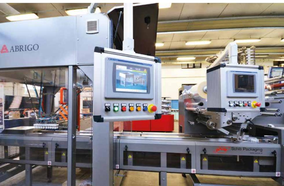
**Abrigo** ha puntato sul nuovo **High Speed MRS**, che integra in una cella robotizzata compatta e ad alte prestazioni (oltre 500 ppm) la possibilità di avere un fine linea con macchinario formatore di cartoni/display o un'unità di alimentazione a macchine multi-flowpack.
